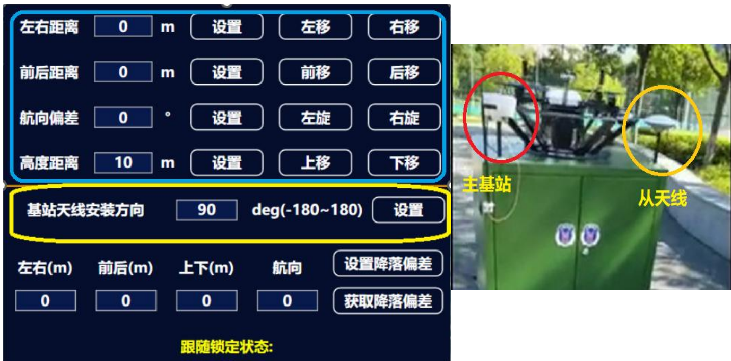
图- 45 RTK 动起降模式基站天向安装方向示意图
